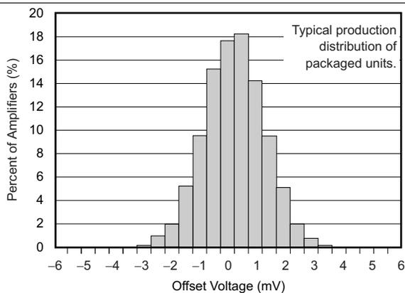
Figure 11. Offset Voltage Production Distribution
