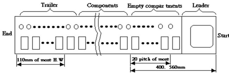
3 DIRECTION THE DIRECTION SHALL BE SEEN FROM THE TOP OF COVER TAPE
