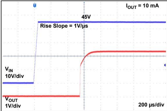
**FIGURE 2-24:** Start-up ( $V_R = 3.3\text{V}$ ).
