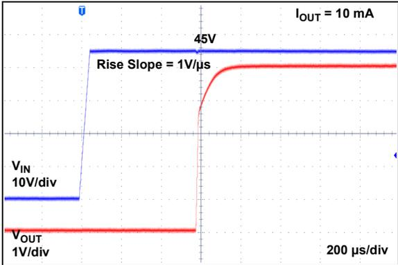
**FIGURE 2-25:** Start-up ( $V_R = 5\text{V}$ ).
