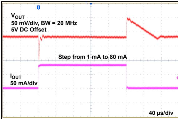
**FIGURE 2-19:** Load Step Response ( $V_R = 5.0\text{V}$ ).
