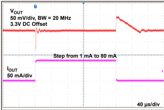
**FIGURE 2-18:** Load Step Response ( $V_R = 3.3\text{V}$ ).
